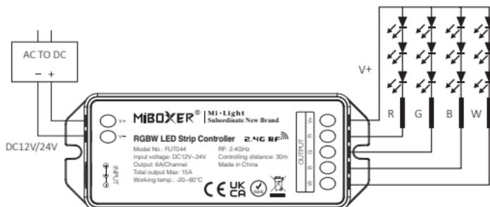
FUT044 Controller mit RGBW-LED-Streifendiagramm verbinden
