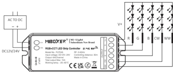
FUT045 Controller mit RGB+CCT-LED-Streifendiagramm verbinden
